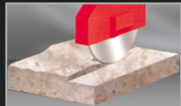
Spinatura di lastre Slabs flattening Planage des dalles
