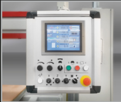
PULSANTIERA PENSILE PENCIL PUSH BOTTON PANEL PANNEAU DES BOUTONS SUSPENDU
